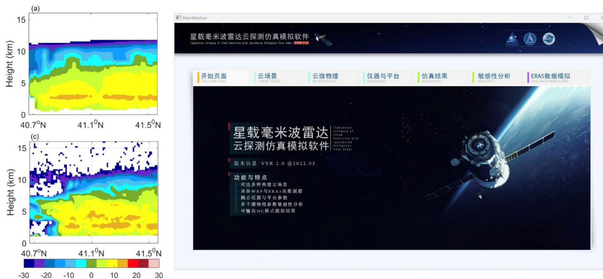
图4 层状云降水个例星载毫米波雷达正演仿真结果及星载毫米波云探测仿真软件
